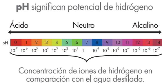
Cuando el pH de una superficie es superior a 9, se pueden presentar diferentes patologías en la superficie como: decoloración por ataque a los pigmentos, entizamiento ocasionado por la degradación de las resinas y/o manchas blancas por migración de hidróxido de calcio (sales) a la superficie.
